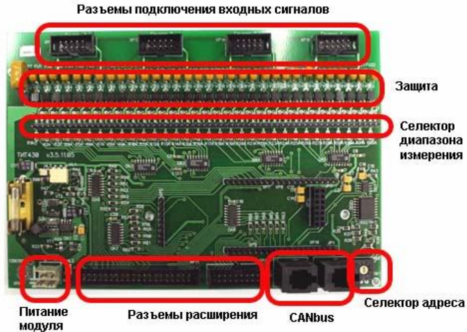
Рисунок 12. Соединительная плата ТИТ430 – основные элементы
