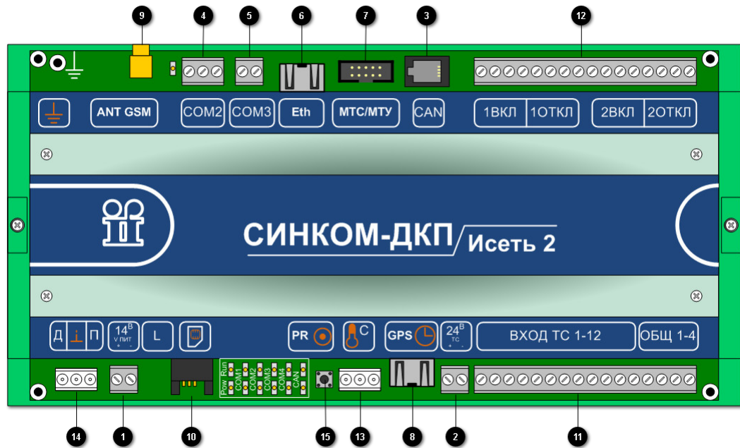
Рис 1.6 Коммуникационный контроллер «Синком-ДКП»/13,8
