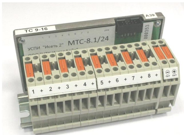
Рис. 14.2. Модуль ввода дискретных сигналов «МТС-8.1/24» (разрывные и проходные клеммы)
