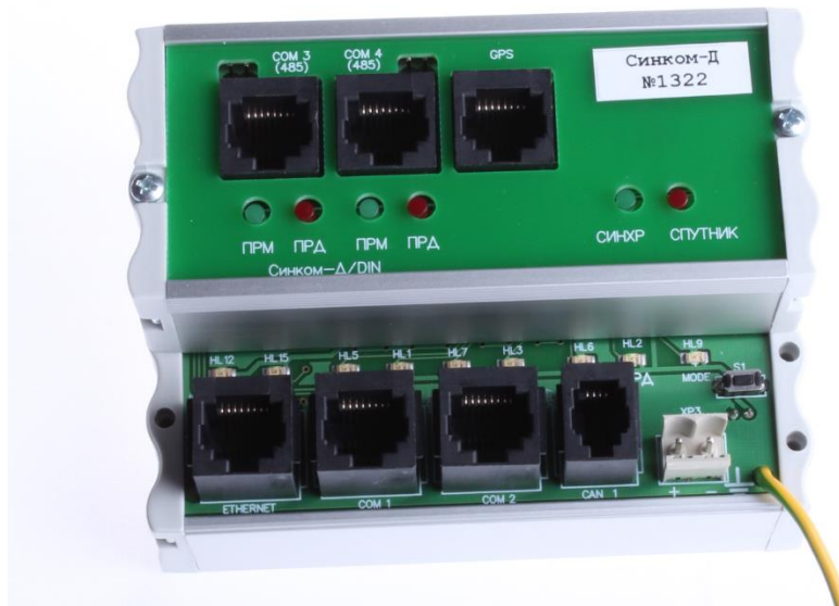
Рис. 7. Коммуникационный контроллер «Синком-Д»
