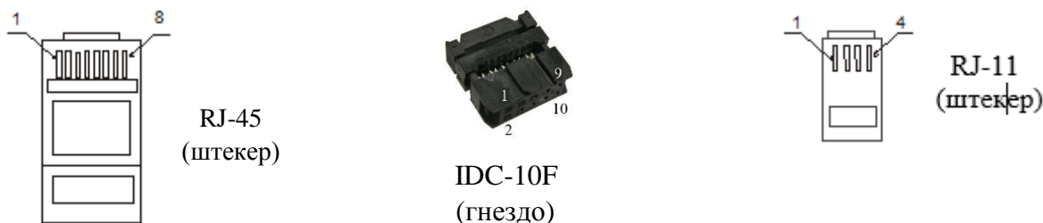
Рис. 3 Расположение контактов разъемов
