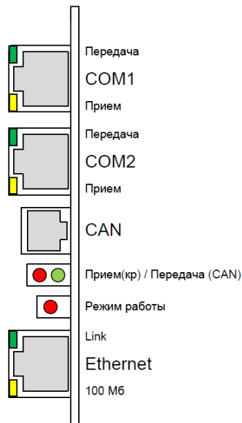
Рис. 2 Размещение разъемов и индикаторов контроллера «Синком-Д/ЗУ»
