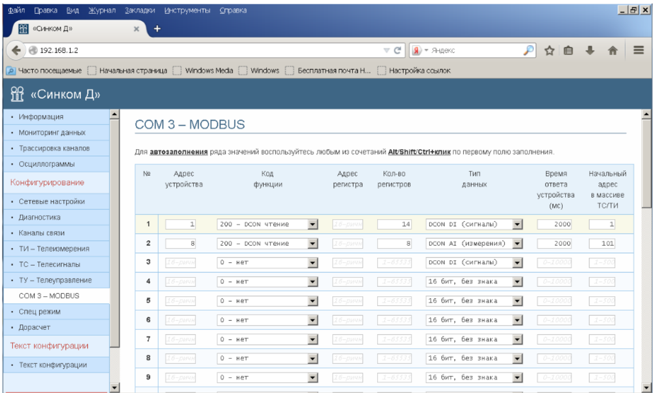
Рис. 1.12-4 Окно настройки «COM 3 - MODBUS» (протокол DCON)
